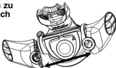
Dichtflächen nicht mit Werkzeugen. Werden das Ausatemventil oder das Gehäuse beschädigt, könnte Ihr Atemregler undicht werden, schwere Fehlfunktionen oder Personenschaden verursachen. Bei der Montage der Blasenabweiser müssen Sie ebenfalls sehr vorsichtig sein. Wenden Sie keine Kraft an, da dies Blasenabweiser, Ausatemventil oder Kunststoffteile beschädigen könnte.
